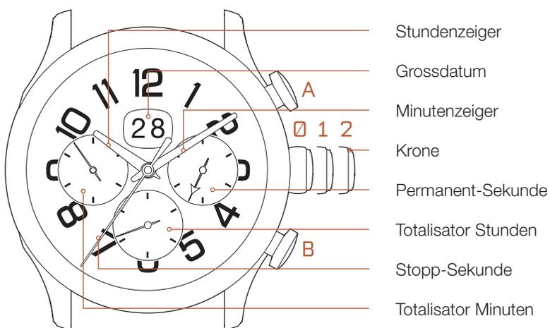
Durch Ihre Handbewegungen wird das komplexe Werk Ihrer Uhr permanent aufgezogen. Legen Sie die Uhr ab, wird sie nach maximal 48 Stunden stehen bleiben. Um sie in Gang zu setzen, folgen Sie den nebenstehenden Instruktionen.
